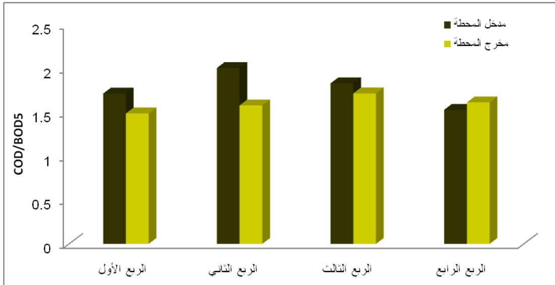
الشكل (22): معدل قيم \left(\frac{COD}{BOD5}\right) لعينات مياه الصرف الصحي في محطة الشيخ سعيد لعام 2011.
